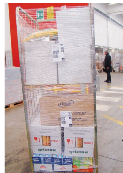
Un tipico roll multi - destinazione: “quando l’operatore preleva il roll e lo carica a bordo del camion il sistema conferma in tempo reale la correttezza di tutte le fasi. In caso contrario attiva un alert”
