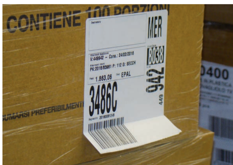
Il tag è applicato in una piega dell’etichetta in modo da agevolare la lettura anche in presenza di grandi quantità di liquidi e di metalli: “il tag associa inequivocabilmente l’unità di carico ad un ordine, ad una baia e ad un autista, e l’autista ad una destinazione”
